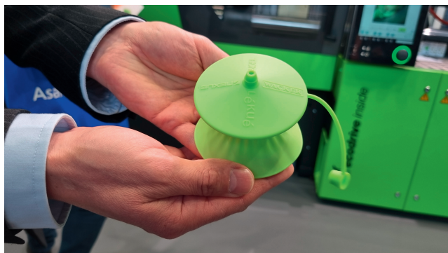
Bild 1. Das Lüfterrad von Ziehl-Abegg besteht aus einem biobasierten und langglasfaserverstärkten PP von Akro-Plastic. © Hanser/F. Streifinger
