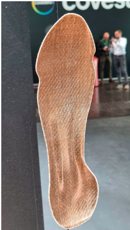
Bild 3. Als Alternative zu üblichen faserverstärkten Materialien (rechts) für die Sohle von Schuhen hat Lanxess ein vollständig biobasiertes Tepex (links) entwickelt. Es besteht aus PLA und ist mit Flachfasern verstärkt. © Hanser/F. Streifinger
